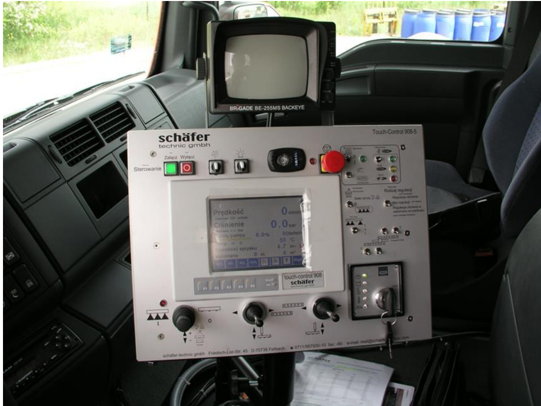
Panel sterujący automatyczną kontrolą skropienia
