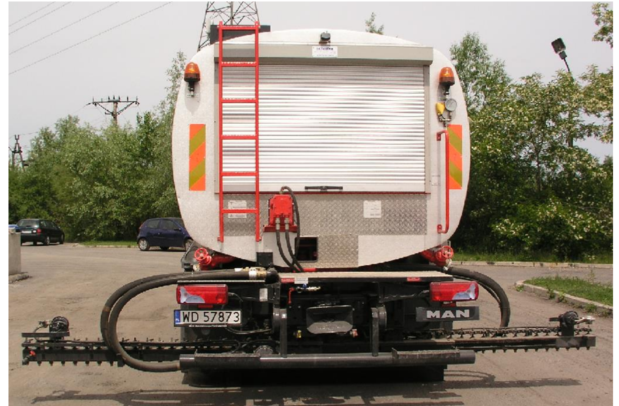
Belka spryskowa skrapiarki – sterowana hydraulicznie
